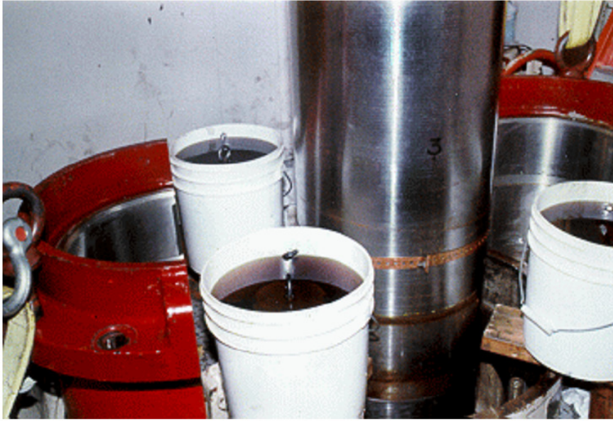
Şekil 8. Düşey şaftta doğrusallık ve şakul ölçümü için eski yöntem ölçüm kurulumu [1].
